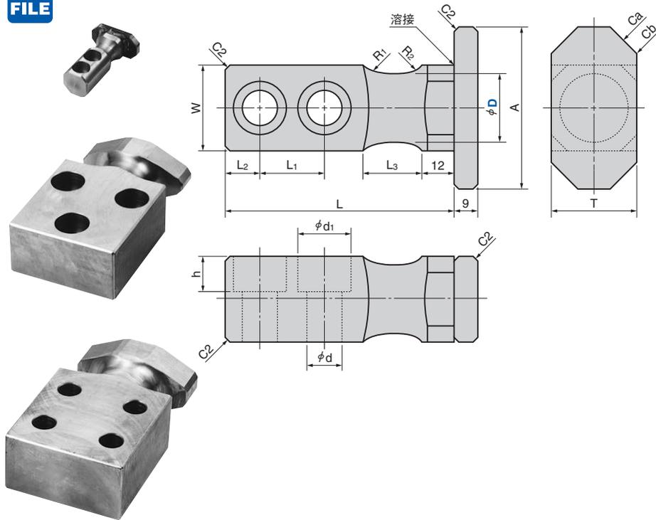
**⚠** 取付ボルト締付け後、フックを型本体に全周溶接して取付けてください。
